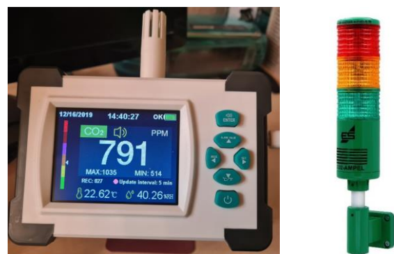
Abbildung 1: Links: kostengünstiges CO 2 -Messgerät mit Datenaufzeichnung (Foto: Privat), Rechts: CO 2 -Ampel "SCHOOL" der Elektrotechnik Schabus GmbH & Co. KG. (Bildquelle: https://www.elektrotechnik-schabus.de/de/warnsysteme-gas-rauch/gasmelder/co2-ampel-school , abgerufen am 08.12.2020)
